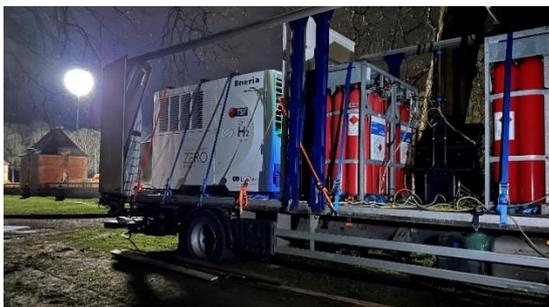
Outre l'absence d'émissions nocives, l'utilisation d'un GEH2®, nativement silencieux, a permis de fournir l'énergie nécessaire à l'utilisation des matériels de tournage sans que celui-ci ne soit perturbé par le bruit du moteur d'un groupe électrogène diesel. La nuit fut ainsi éclairée sans nuisances par un ballon HMI Daylight de 18 kW simulant la lumière de la lune pour accompagner les acteurs aux abords du château.
